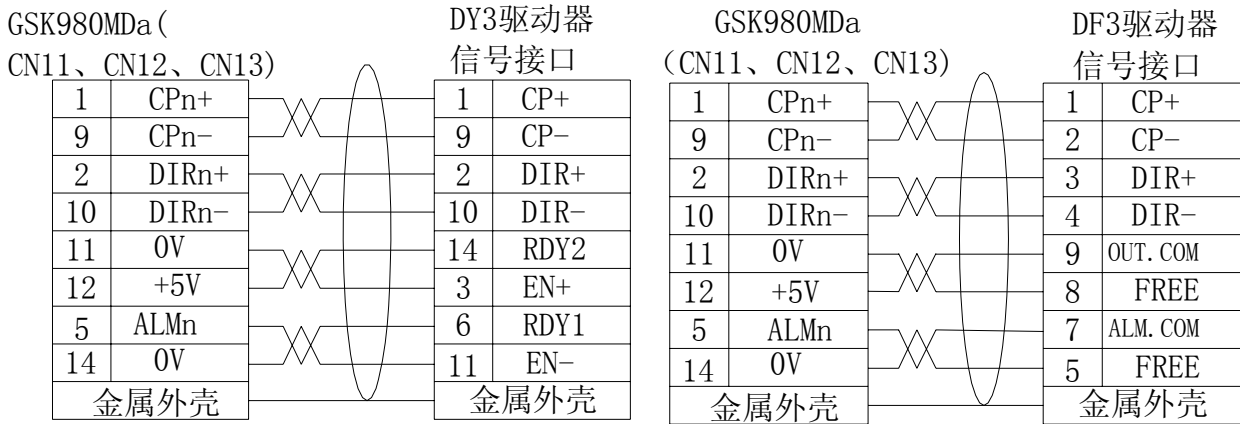
图 2-10 GSK980MDa 与驱动单元的连接
